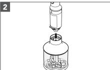
Alinee el accesorio de picadora con el cuerpo del motor y empuje uno contra otro. No gire el cuerpo del motor hasta que encaje en su sitio.
