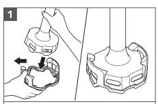
Si utiliza un protector de utensilios, colóquelo sobre una superficie plana. Para insertar el protector de utensilios, gire el brazo batidor hacia uno de los lados del clip de montaje. A continuación, tire suavemente del otro clip de montaje hacia fuera y empuje el brazo batidor hacia abajo. Asegúrese de que los clips de montaje están bien fijados en su sitio.
