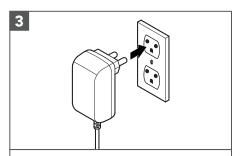
Enchufe el adaptador de carga a una toma de corriente con toma de tierra.
