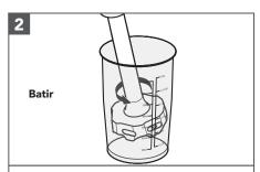
Introduzca la batidora de mano inalámbrica en la mezcla. Pulse el regulador de velocidad variable y el interruptor manual al mismo tiempo para comenzar. Utilice la otra mano para sostener la jarra, de modo que pueda obtener una mejor estabilidad y evitar las salpicaduras.
