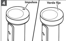
El indicador de estado de la batería parpadea cuando esta se carga. La batería se cargará por completo en 2 horas, cuando el indicador de estado de la batería se ilumine en verde fijo.
