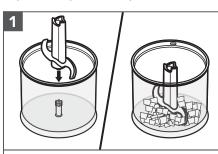
Inserte la cuchilla de la picadora en el recipiente de la picadora. Añada los ingredientes al recipiente.
