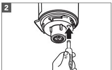
Inserte la clavija del adaptador de carga en el puerto de carga.
