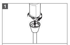
Para cargar la batería, gire para desbloquear y extraer el brazo batidor.
